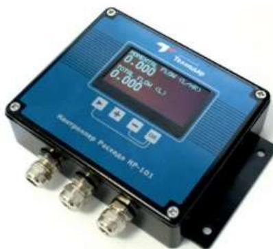
Измерение и вычисление расхода с учетом разности температур измеряемой среды. Многофункциональный дисплей и возможность подключать разные типы расходомеров с различными типами сигнальных выходов.
